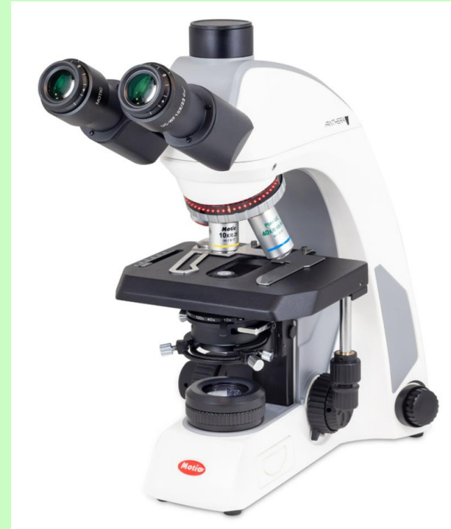
Durchlichtmikroskop übliche Vergrößerung 40-1000 fach
